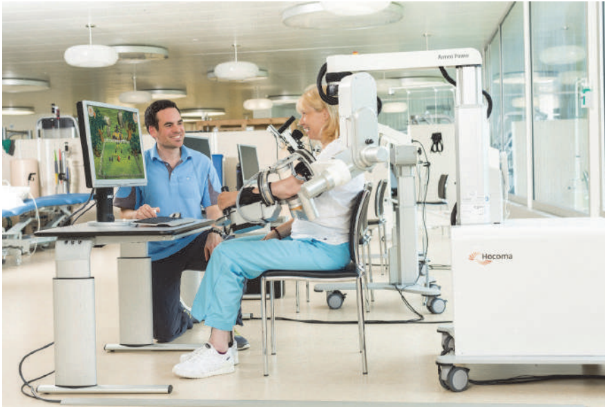
Figure 3. Robot de rééducation employé dans la réhabilitation motrice des membres supérieurs [Société Médimex, Sainte-Foy-lès-Lyon, France].
