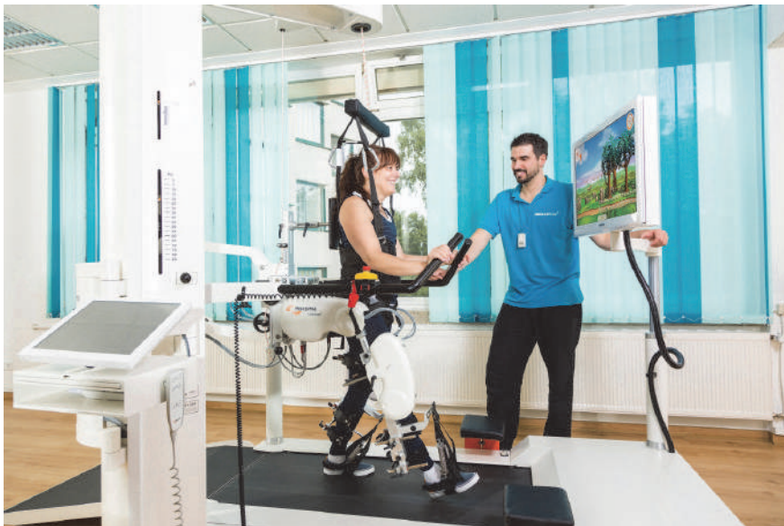
Figure 4. Robot de rééducation employé dans la réhabilitation motrice des membres inférieurs [Société Médimex, Sainte-Foy-lès-Lyon, France].
